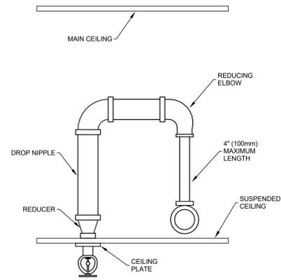
**SPRINKLER HEAD BELOW CEILING - REDUCING ELBOW**
